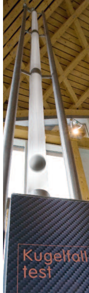
Высота падения 5 м, масса 1 кг = 50 Дж: стальной шар не наносит армированному углеродным волокном покрытию никаких повреждений
