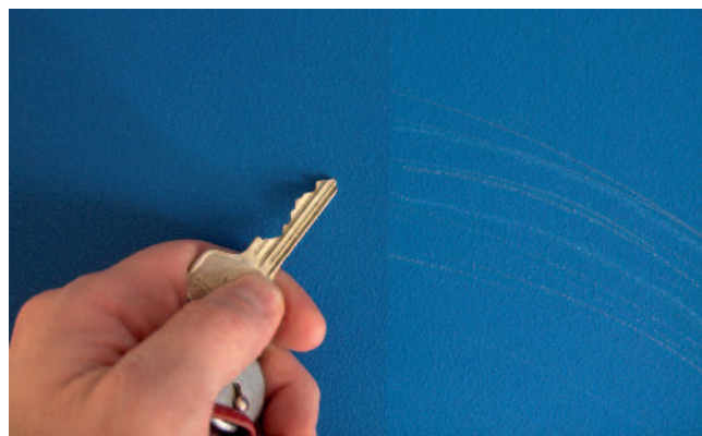
Испытание на твердость царапанием доказывает: у PremiumColor эффект белых полос отсутствует (левая часть картинки)
